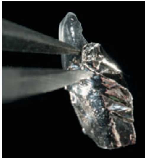
Abb. 20 Nach dem Glanzbrand kann die Platinfoolie mit einer Pinzette einfach aus der Keramik herausgelöst werden.
