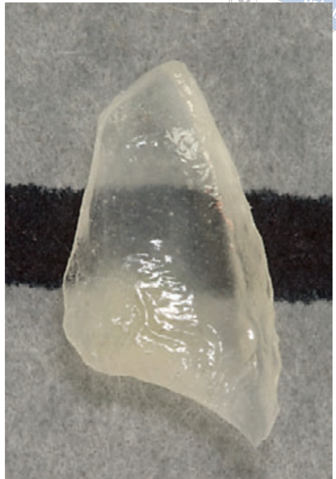
Abb. 32 Das definitive Veneer, gefertigt auf Platinfolie mit individueller Schichtung. In der Kontrastaufnahme erkennt man die gezielt unterschiedlich getrübbten Bereiche (vgl. Abb. 23 bis 25).
