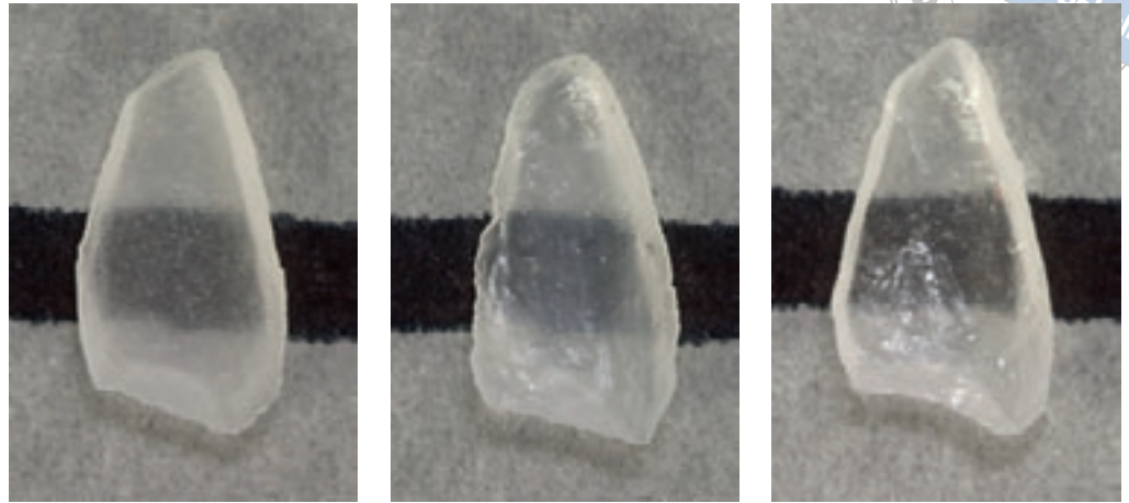
Abb. 23 bis 25 Der Transparenzvergleich der Testveneers. Das presskeramische (23), das auf feuerfestem Stumpf gefertigte (24) und das auf Platinfolie erarbeitete Veneer (25) zeigen deutlich unterschiedliche Transparenzgrade.
